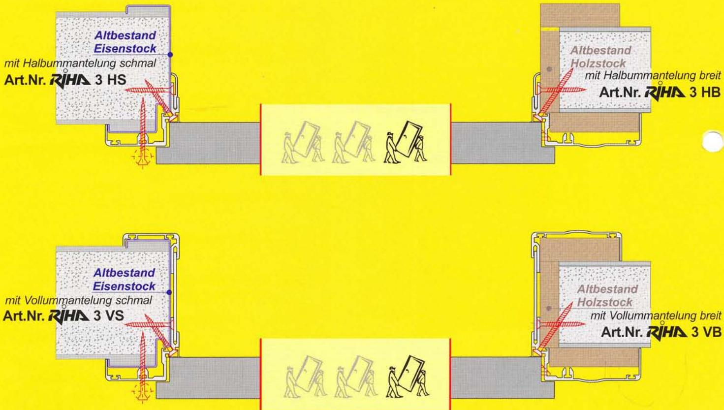
Sicherheitstürblatt mit Sicherheitszarge RIHA WK3, eingebaut in eine Stahl- oder Holzzarge mit Halb- oder Vollummantelung.
